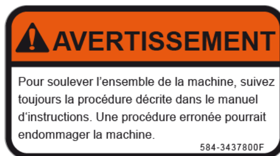
(23) Avertissement sur la position de la charge soulevée (584-3437800)
