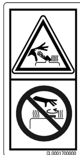
(20) Avertissement contre le risque de brûlures (CL000170000) [2 emplacements]
