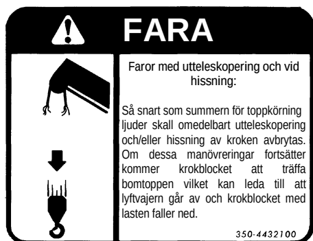
(23) Fara vid toppkörning (350-4432100)
