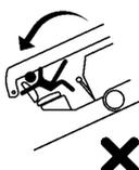
Pour le déplacement sur une pente ou des planches d'une rampe, positionnez votre porteur de telle manière que le siège de l'opérateur soit élevé. Dans le cas contraire, en cas de glissement du porteur, l'opérateur risque d'être blessé.
