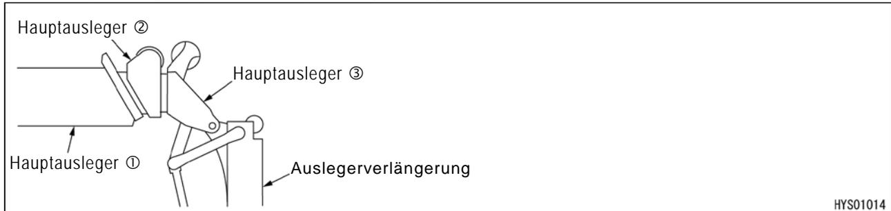
2. Hauptausleger (2): Bei ausgefahrenem Hauptausleger soweit, dass die erste "▲" Markierung des Hauptauslegers (2) sichtbar ist.
