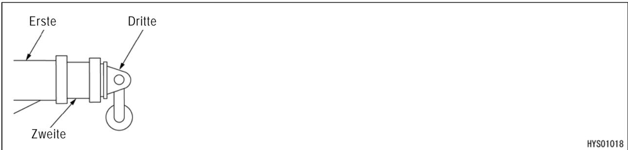
2. "Zweite": In der zweiten Stufe Auslegerverlängerung vollständig ausgefahren.
